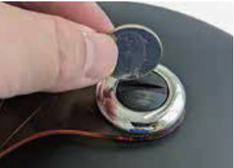
①ビスをコインなどで緩め、順次、取り付け部品、シールドを取り外す
