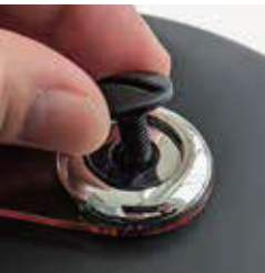
③ワッシャーを上被せ、ビスをコインなどで締める
