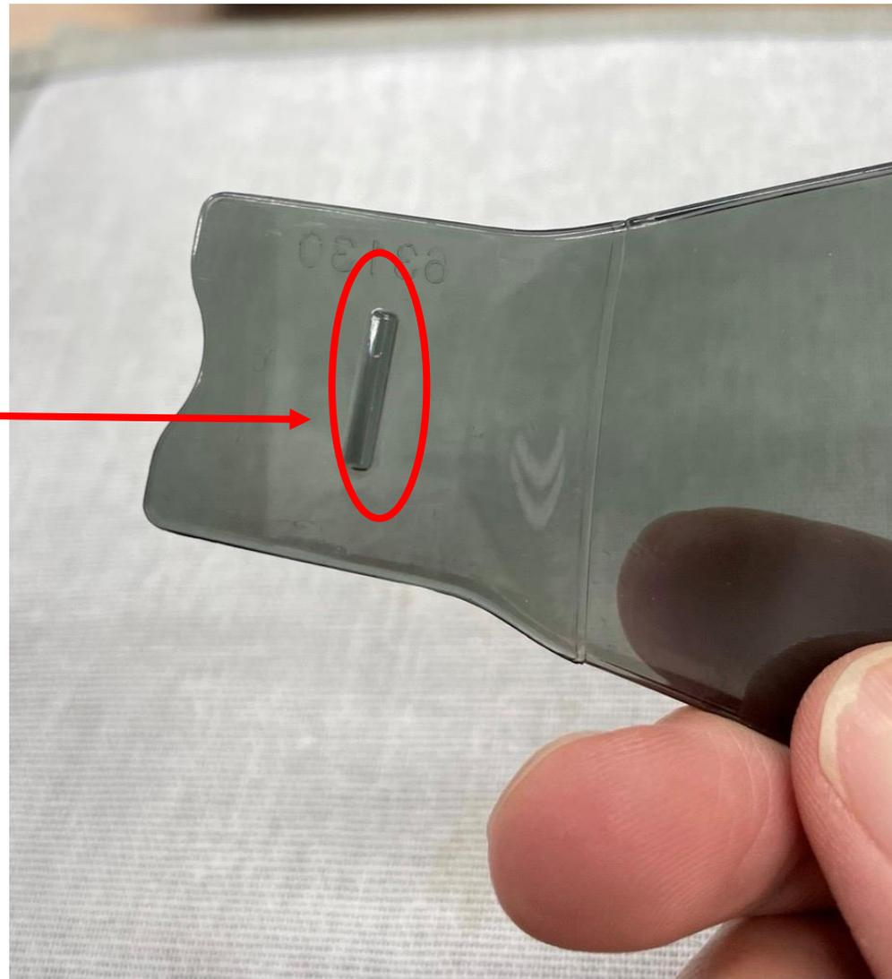
赤丸の凸をヘルメット本体内側にあるベースに差し込んでとまっています。ですので軽く引き抜くと外れる仕組みです。引き抜くと「パチン」と音が鳴って外れます。
